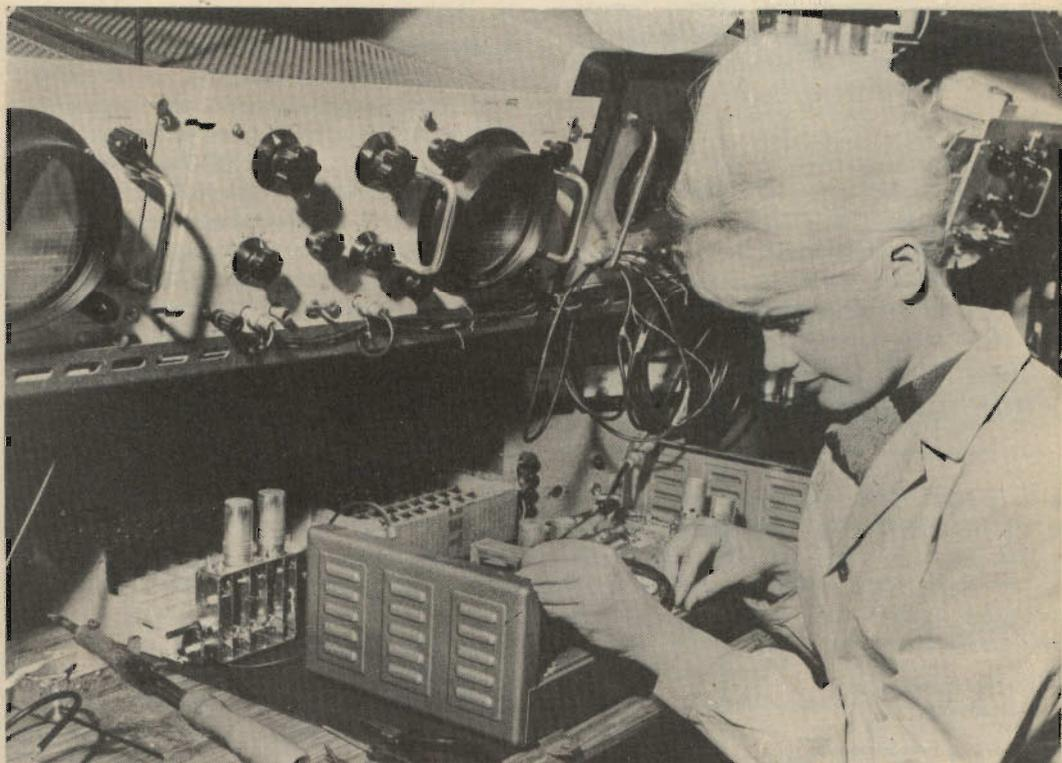
Operazioni finali di un assiemaggio di un modernissimo amplificatore miscelatore atto a funzionare alle ultrafrequenze televisive.
